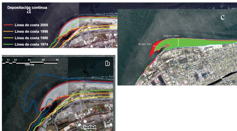
Figura 8. Diversas visualizaciones del proceso de acreción/erosión en Playa Norte, Isla del Carmen para el periodo 1974-2008. La imagen (Ikonos) corresponde al año 2008. Detalle de la lengüeta de sedimentos. En color azul su extensión en el año 2001. Detalle de los procesos de acreción (verde) y de erosión (rojo).
