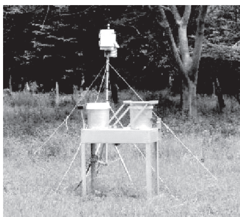
Figura 4. Estación meteorológica automática y colector automático para deposición húmeda y seca en el Campamento de Arqueólogos de la Zona Arqueológica de El Tajín, Veracruz.
