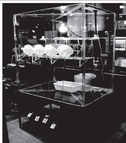
Figura 5. Cámara de intemperismo acelerado de deposición ácida.
